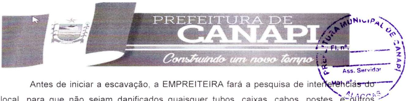
Antes de iniciar a escavação, a EMPREITEIRA fará a pesquisa de interferências do local, para que não sejam danificados quaisquer tubos, caixas, cabos, postes, e outros elementos ou estrutura que estejam na zona atingida pela escavação ou em área próxima a mesma.
